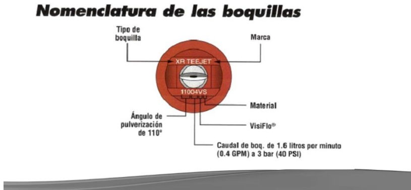
Figura 18. Explicación de la nomenclatura (códigos) en una boquilla.
